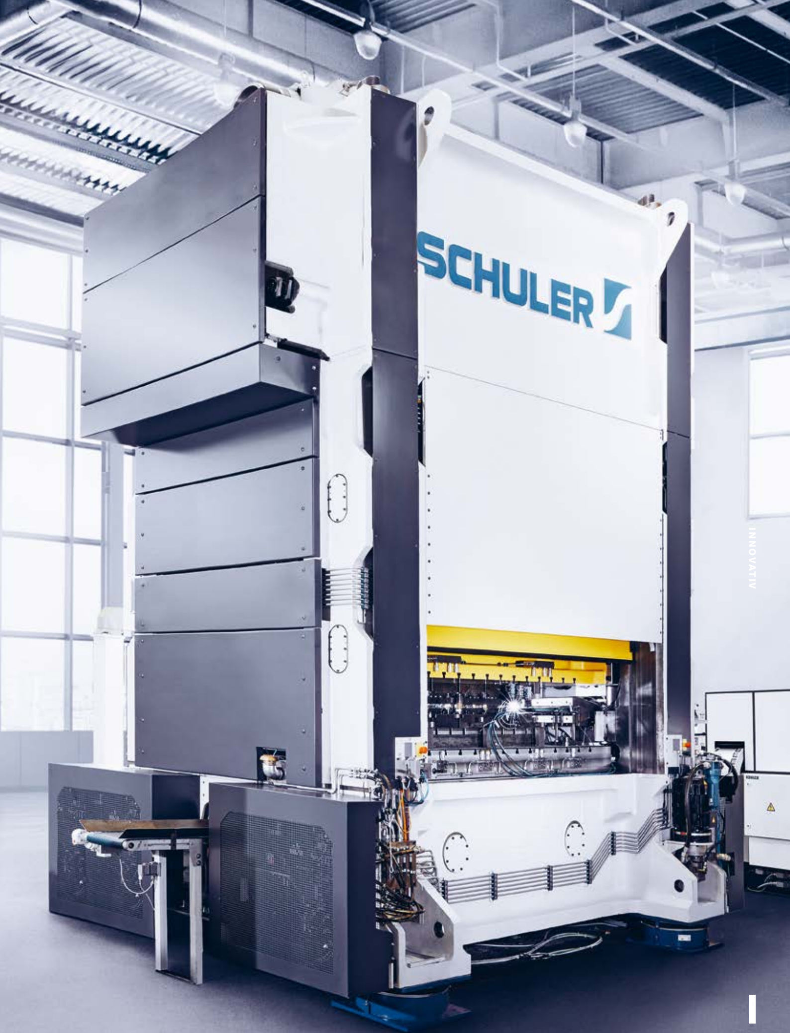
Die innovative Smartline-Pressen von Schuler formt aus bis zu 0,2 Millimeter dünnen Stahlblechen Komponenten für Elektromotoren. So reduzieren sich das Gewicht der Elektroautos und die Energieverluste des Motors.
