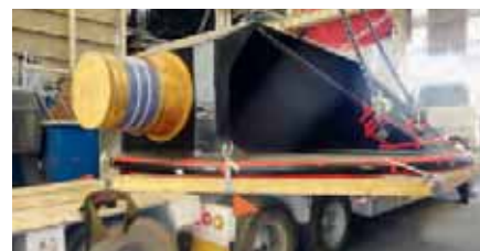
Подготовка 80-тонного ротора затвора к транспортировке
