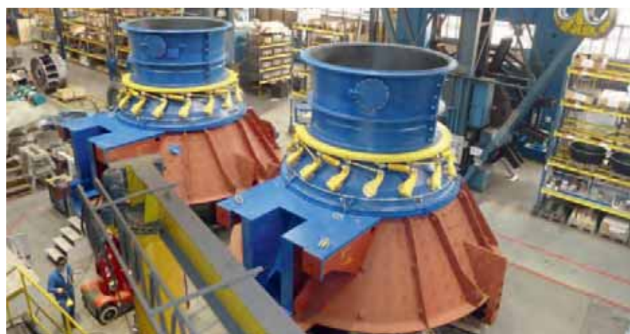
Компактные осевые капсульные турбины для ГЭС «Lixhe» во время сборочных работ в цеху
